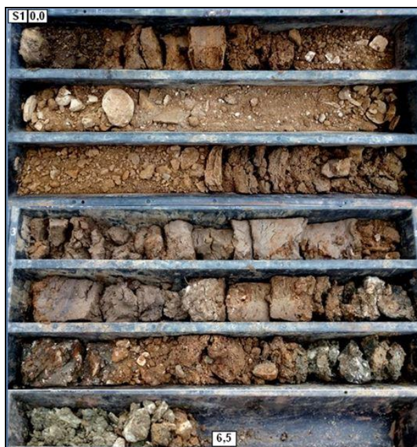
Obrázek č. 1 Sonda S1: 0,0–6,5 m
